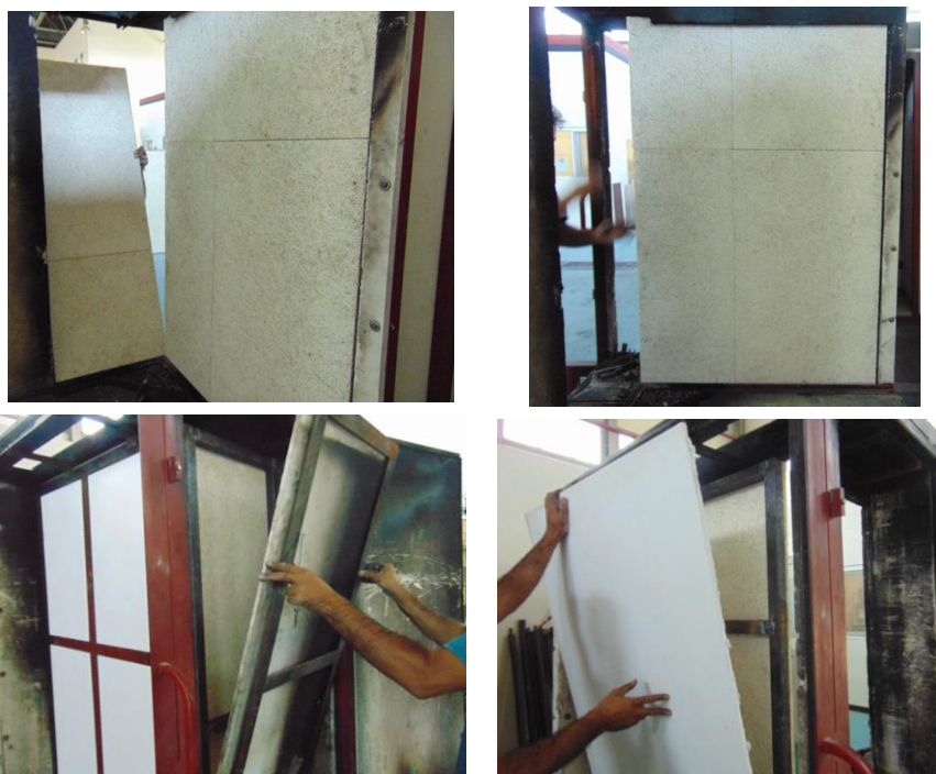
شکل ۲- مراحل نصب آزمون عایق تخته‌ای پشم چوب در قاب آزمون SBI
